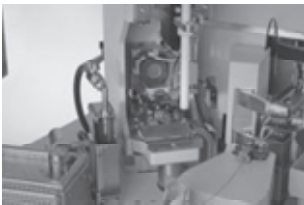
Конфигурация для скручивания, флюсования, лужения.
