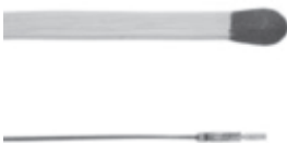
Пример обработки провода AWG 36.
